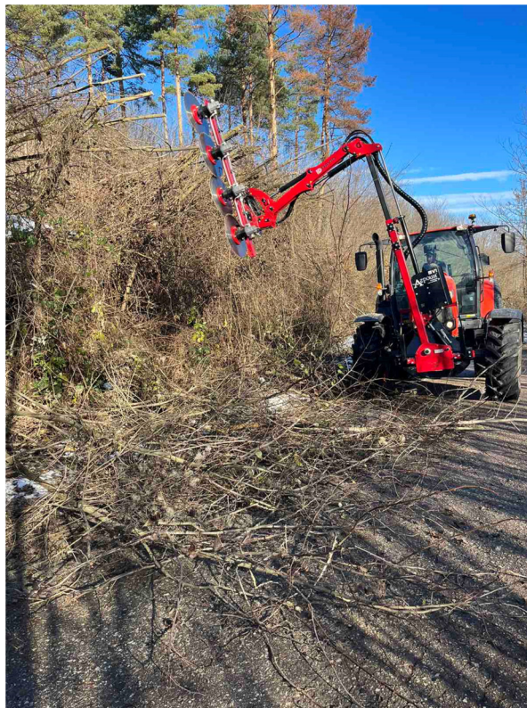
сн. 16 и сн. 17 – почистване на надвиснали клони по общинска пътна мрежа с новопридобития трактор
