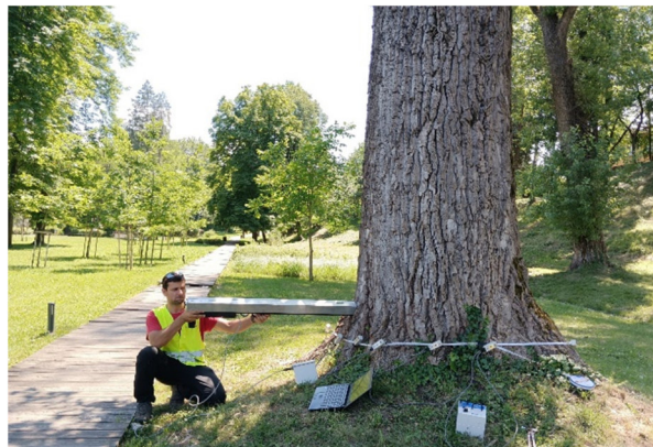
сн. 19 – обследване на дървесна растителност със сонда за измерване съпротивлението на дървесината (резистограф)
