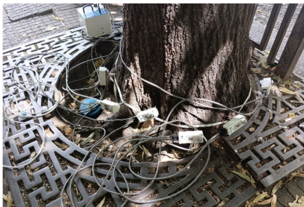
сн. 18 – обследване на дървесна растителност с импулсен томограф
