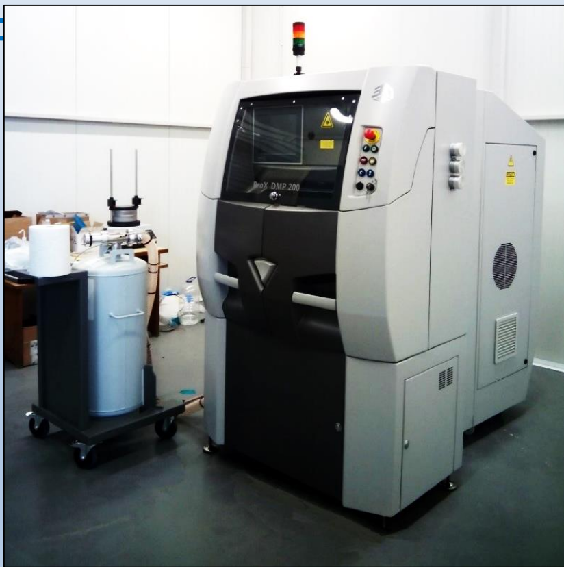
3D принтер за метали ProX 200 Софтуер за адитивни технологии - 3D Xpert
