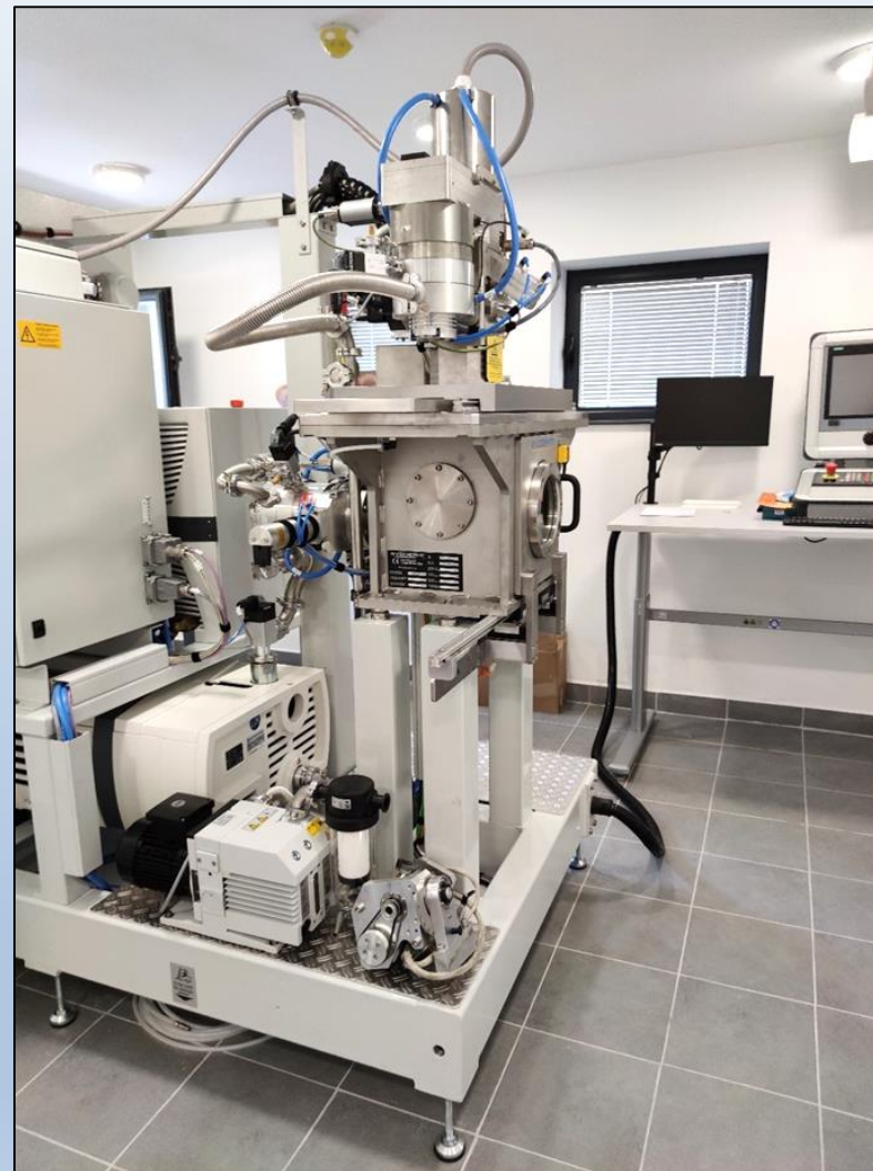
Иновативна инсталация за електронно-лъчевото заваряване във вакуум EvoBeam
