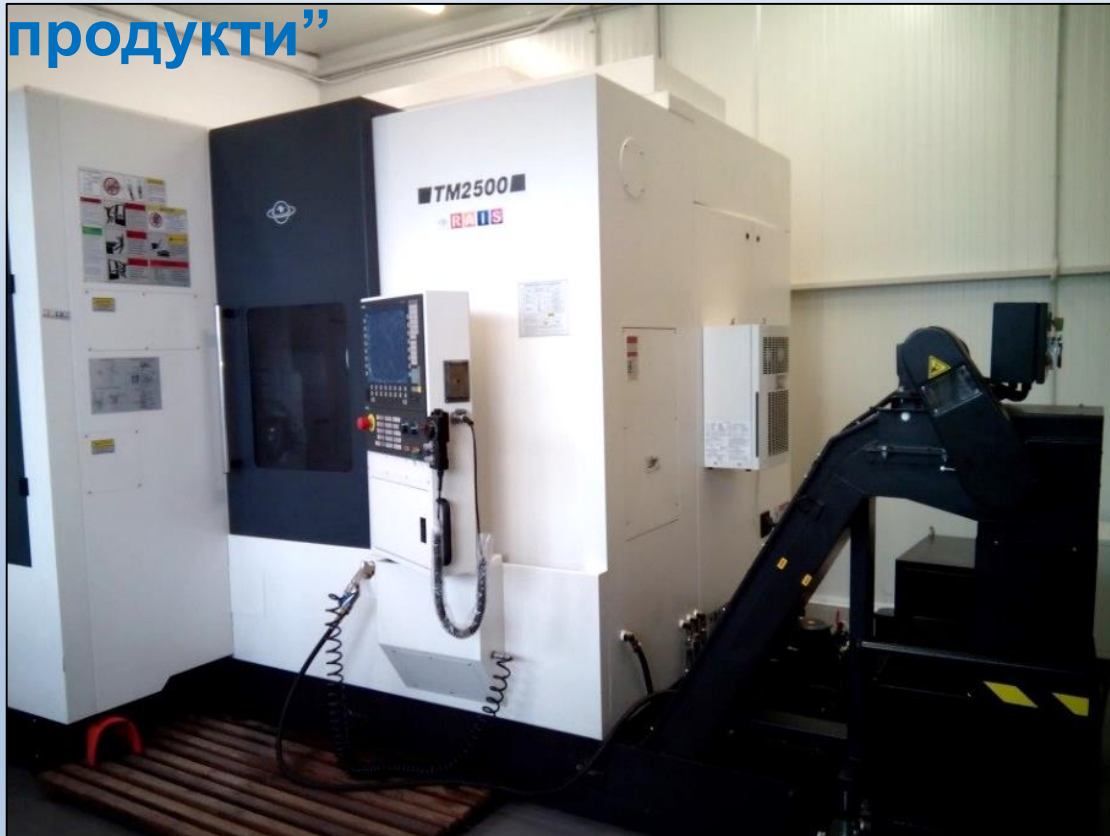
Пет-осов струго-фрезови обработващ център T2500. CAD/CAM софтуер
